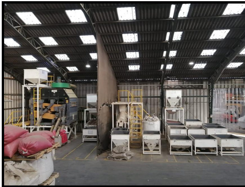
Zona donde quedan las máquina y tolvas dentro de la bodega, sin contacto con semilla en almacenamiento.
